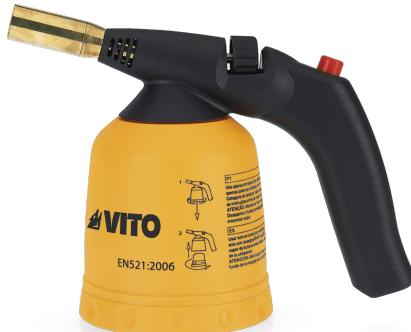
Maçarico com Isqueiro equipado com acendimento automático, tem uma potência de 1,7 kW, tem um consumo de 123 g/h, com um tempo de trabalho > 1h40m, utilizando gás Butano, recargas EN417-TIPO200.
