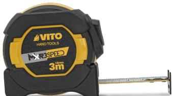
Flexómetro en acero con revestimiento de nylon, tiene una caja en ABS con revestimiento en goma, con mosquetón ideal para mediciones verticales, tiene un botón de bloqueo y retroceso automático, con escala en milímetros en ambas caras.
